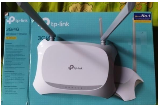
Gambar 2. Router TP-Link TL-MR3420
